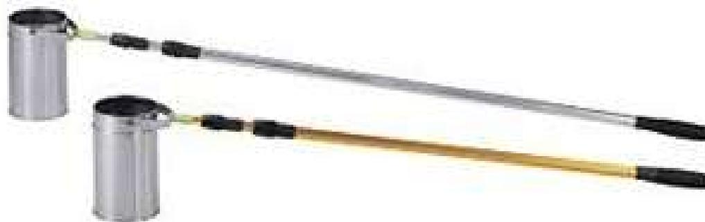
(3) **採樣瓶**：由金屬支撐架固定採樣瓶(圖3.5)。
