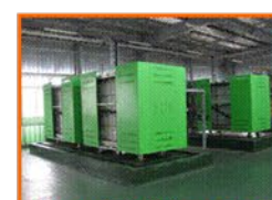
尼龍纖維製造廠 廢水以EDR脫鹽 回收做為冷卻水 塔補充水 (800 m 3 /day)
