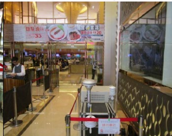
說明：室內空氣品質檢測(CO、CO 2 、PM 10 ) 日期：2017/08/09~2017/08/10 地點：1F大廳(巡檢點1)
