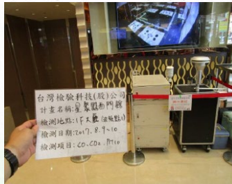
說明：室內空氣品質檢測(CO、CO 2 、PM 10 ) 日期：2017/08/09~2017/08/10 地點：1F大廳(巡檢點1)
