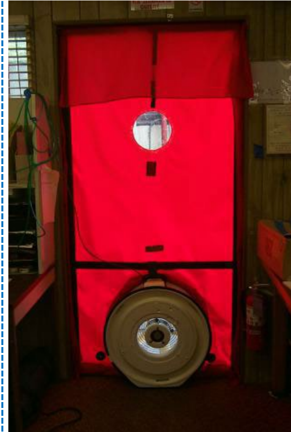
Blower door test
