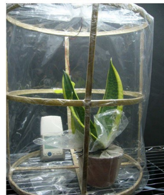
圖一、PP材質熏氣箱，容積約52公升，附小型電風扇作為氣體攪拌之用。
