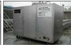
食品業RO濃縮 水利用EDR脫 鹽回收再利用 (300 m 3 /day)
