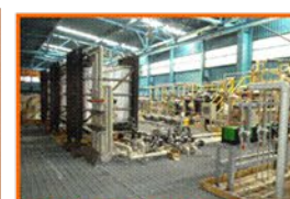
鍍鋅製程廢水以 EDR脫鹽回收做 為清洗水 (700 m 3 /day)
