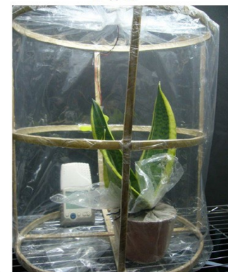
圖一：PP 材質熏氣箱，容積約 52 公升，附小型電風扇作為氣體攪拌之用。
